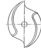
Bild 11: Offenes Zweikanalrad mit S-förmigen Schaufeln
