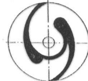
Bild 9: Geschlossenes Einkanalrad (Draufsicht ohne Deckscheibe dargestellt)
