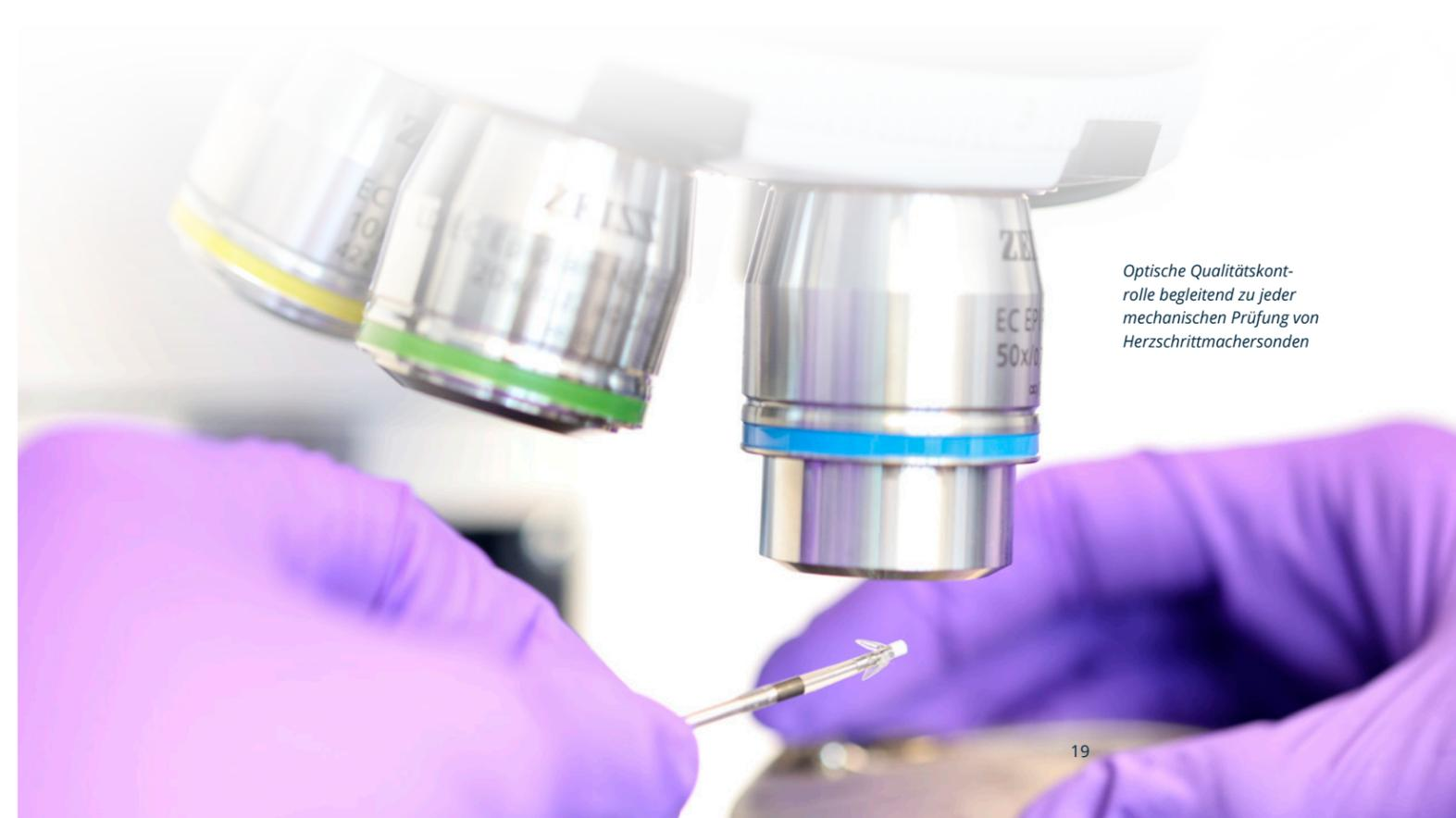
Optische Qualitätskontrolle begleitend zu jeder mechanischen Prüfung von Herzschrittmachersonden
