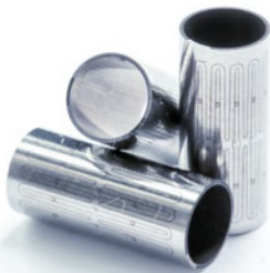
Prozessschritte bei der Herstellung von Stentstrukturen mittels Femtosekunden-Laserschneider – vom Schneiden der Rohrrhalbzeuge über die mechanische Nachbearbeitung bis zur Formgebung durch Wärmebehandlung
