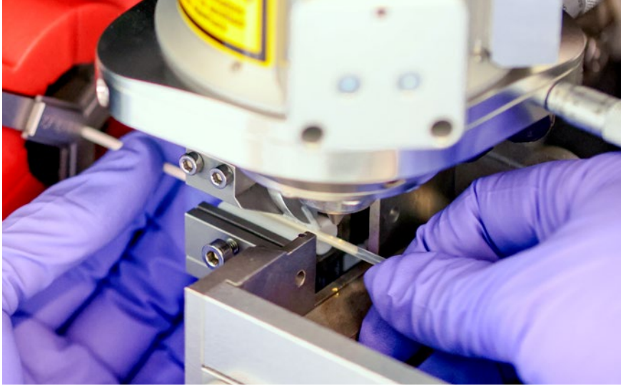
Schneiden und Mikrostrukturierung von Polymeren und Metallen mittels Femto-Sekunden-Lasertechnologie
