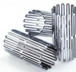
Prozessschritte bei der Herstellung von Stentstrukturen mittels Femtosekunden-Laserschneider – vom Schneiden der Rohrrhalbzeuge über die mechanische Nachbearbeitung bis zur Formgebung durch Wärmebehandlung
