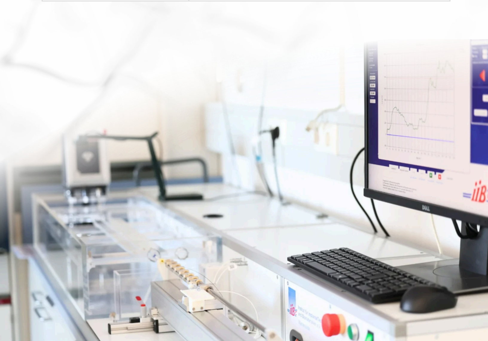
Spezialprüfstand PUSH zur Bestimmung der proximalen und distalen Reaktionskräfte bei der simulierten Anwendung von Kathetern in arteriellen Gefäßmodellen.
