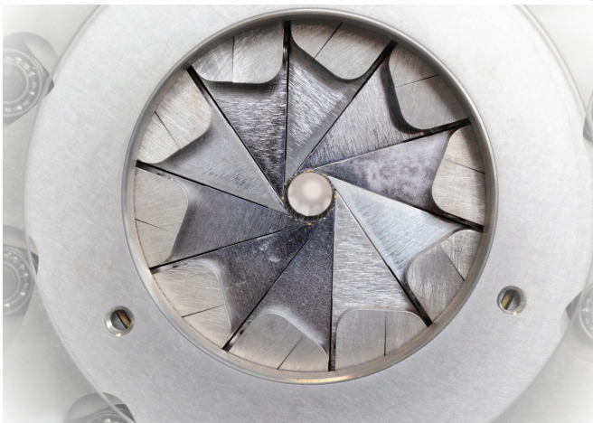
Radialkrafttester Blockwise TTR2; Irisblende des Twin-Cam Compression Station RLU248- Prüfkopfes (Durchmesserbereich: 0 - 60 mm)
