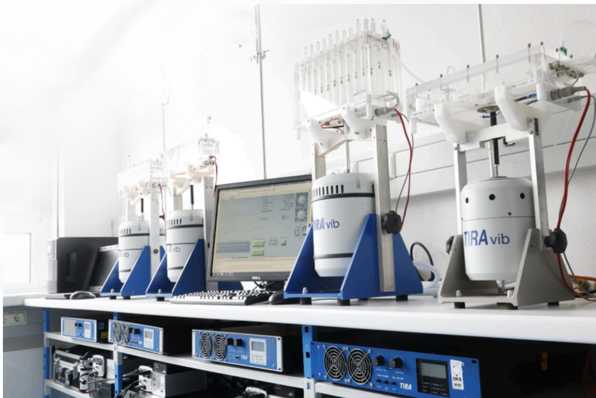
Es existieren diverse Prüfkammern für unterschiedliche Prüfkonfigurationen. Sie unterscheiden sich hinsichtlich der Anzahl der Prüfmuster pro Kammer als auch der Anordnung in gebogener oder gerader Prüfkongfiguration.
