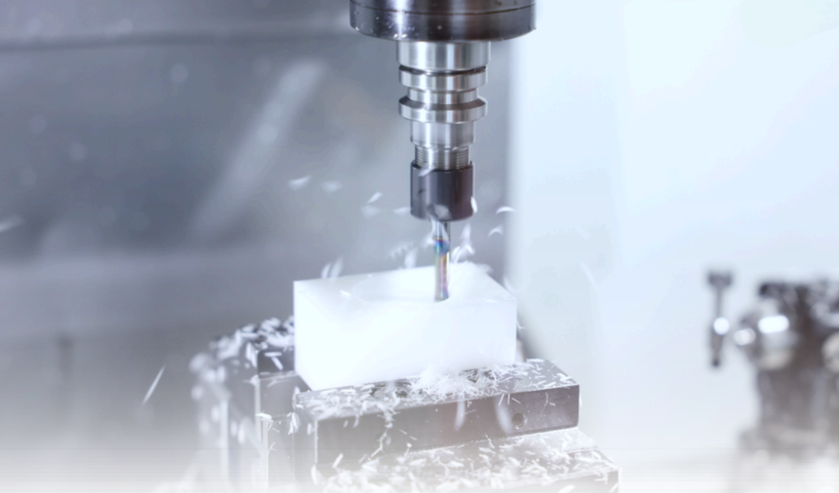
Feinmechanische Arbeiten eines Kunststoffbauteils mittels Dreiachs-CNC-Fräsmaschine – die technische Umsetzung erfolgt am IIB e.V. durch erfahrene Elektronik- und SoftwareentwicklungsingenieurInnen sowie durch KonstrukteurInnen und FeinmechanikerInnen
